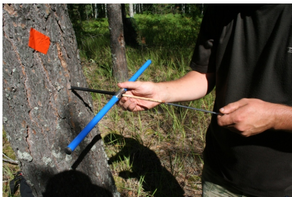
Взятие образца древесины буром Пресслера
